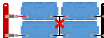
N'interconnectez pas les points médians et ne connectez rien d'autre aux points médians
