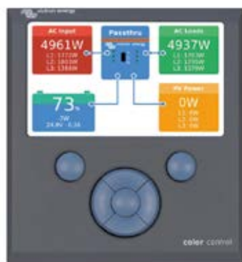
Color Control GX montrant une application PV
