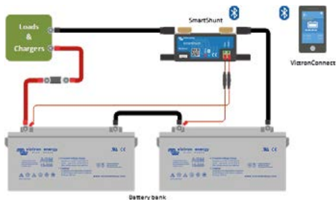
Mesure du point médian du banc de batteries
