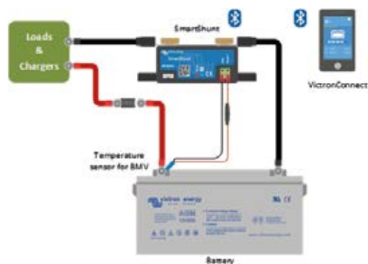
Mesure de la température de batterie
