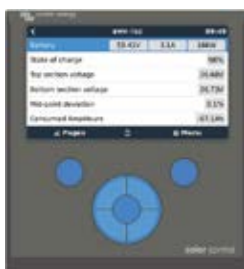
Color Control De krachtige Linux-computer, verborgen achter het kleurendisplay en de knoppen, verzamelt gegevens van alle Victron-apparatuur en geeft deze weer op het display. Behalve met Victron-apparatuur communiceert de Color Control via NMEA 2000, Ethernet en USB. De gegevens kunnen op het VROM Portal worden opgeslagen en geanalyseerd. Voor bewaking en besturing staan iPhone- en Android-apps ter beschikking. https://vrm.victronenergy.com/
