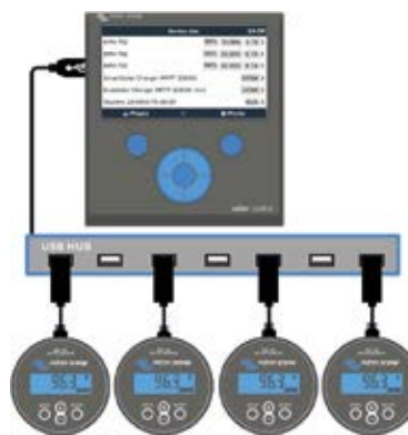
Maximaal kunnen vier BMV's direct op de Color Control worden aangesloten. Voor centrale bewaking kunnen nog meer BMV's via een USB hub worden aangesloten
