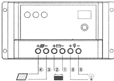
Achten Sie darauf, dass die Nennwerte für die Solaranlage und die Last nicht überschritten werden.
