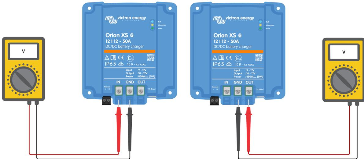
La raison pour laquelle la tension de la batterie est mesurée aux bornes du chargeur est que cela permet d'exclure d'éventuels problèmes de câblage, de fusibles et/ou de disjoncteurs sur le trajet entre la batterie et le chargeur.
