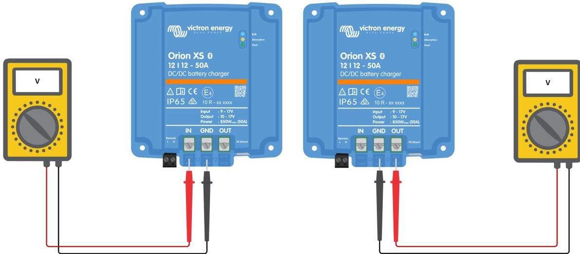
A razão para medir a tensão da bateria nos terminais do carregador solar é a exclusão de potenciais problemas na cablagem, nos fusíveis e/ou nos disjuntores no percurso entre a bateria e o carregador.
