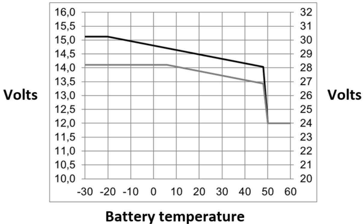
El gráfico anterior muestra las tensiones de salida por defecto para flotación y absorción a 25 °C para bancadas de baterías de 12 V y 24 V. Para una bancada de baterías de 48 V, multiplique las tensiones de 24 V por 2.
